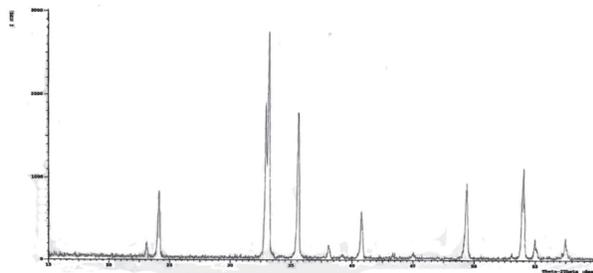
Fig. 2. The XRD test of  $MnFe_2O_4$ .
