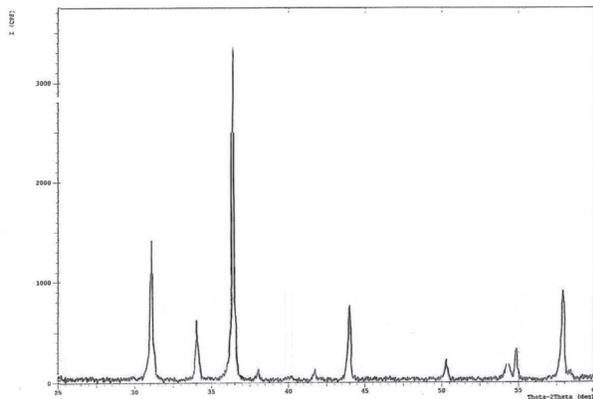
Fig. 1. The XRD test of  $MgFe_2O_4$ .
