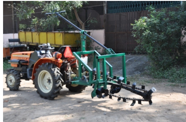
Fig. 2. Mini tractor operated prototype trencher
